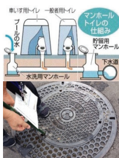
益城町マンホールトイレの仕組み・外観・内観
